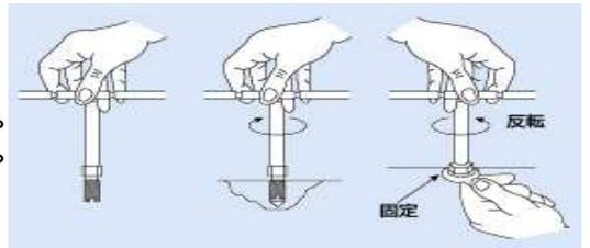
※高硬度アルミ、ステンレス、高硬度材などはタップが必要な場合があります。別売りでご用意しております。その場合、エンザートの長さの1/2～2/3程度のタップ加工を行うことによりエンザートを確実に入れることができます。エンザートを確実に固定させるため、残りの1/3～1/2はセルフタップで加工して下さい。
